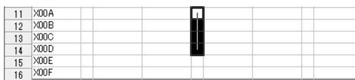
4. 配線の始点アドレス位置をマウス左ボタンでクリックし、左ボタンをクリックしたまま配線を引く方向にマウスを動かします。(ドラッグします。)
