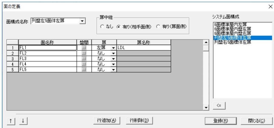
2F 用の盤は列盤右 5 面標体左扉で下記画面の面の定義に設定します。
