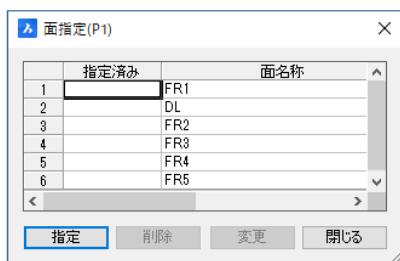
「盤定義・面定義」で、盤 P1 は「6 面標準屋内左扉」で指定したので、面名称の一覧には FR1、FR2、FR3、DL、FR4、FR5 が表示されています。まず、「FR1」の行を選択して [指定]ボタンを押し、該当の面全体が入るように矩形で囲みます。FR1 は左側面ですので、配置図の左側面を枠で囲みます。配置図に枠と配置面名称が追加され、下記の画面が表示されます。
