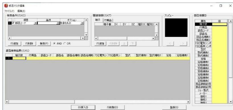
設定する部品情報の項目は、目的(部品リスト作成、「シンボル入力(部品マスター)」コマンド利用など)によって様々ですが、布線処理で必要な項目は「部品コード」と「型式」です。その他は必要に応じて設定してください。下記内容を指定したら、一旦ここで登録します。
