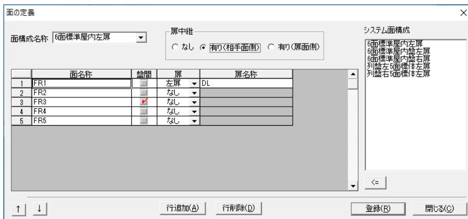
1F 用の盤は列盤左 5 面標体左扉で下記画面の面の定義に設定します。
