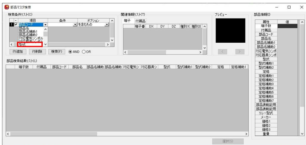
検索条件リストの項目に「型式」を指定、条件として「ABN110」を入力し、「オプション」として「を含むもの」を指定して「検索」ボタンを押すと、見つかった部品情報が部品検索結果リストに表示されますので、データを選択します。
