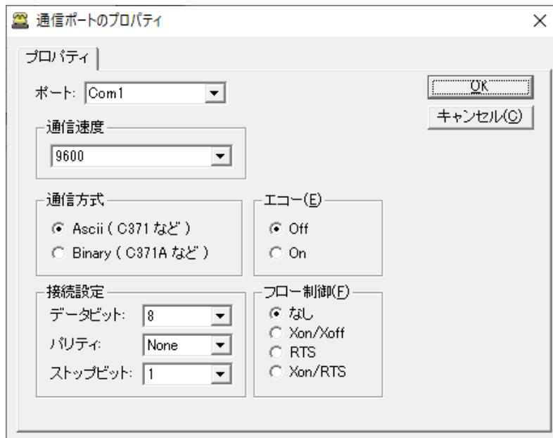
CASTING C371A 等との接続時は、通信方式を Binary に設定します。
