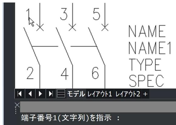
4. つづいて、コマンドバーに「端子 1 の間近の配線(Line)を指示」と表示されます。端子に接続されている線を指示します。
