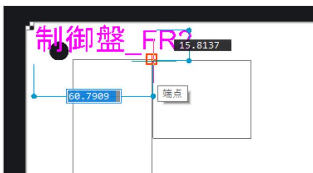
17. Ctrl キーを押して、基点を横向きダクトの左上に変更します。
