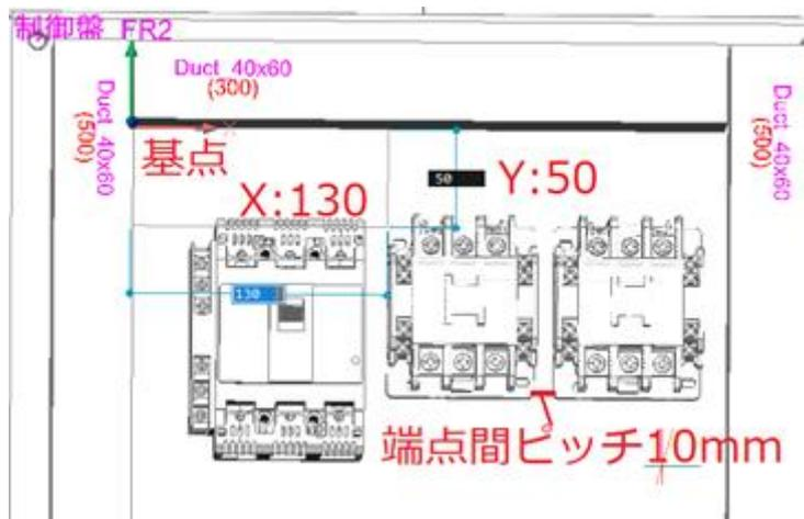
9. [器具選択]ボタンをクリックし同様の手順で「MC1」、「MC2」、を MCB1 の横に配置します。
