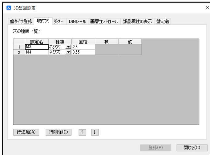
1. [取付穴]タブをクリックします。情報にはネジ穴、バカ穴、矩形穴、長穴（長円）が設定できます。
