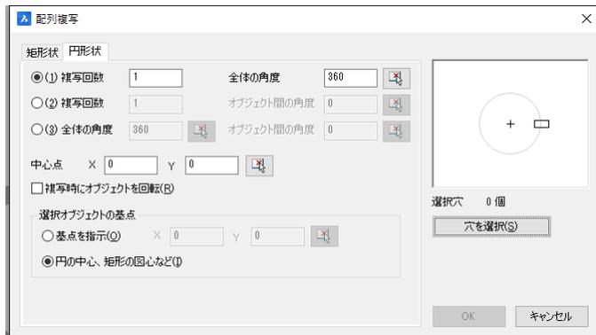
1. メニューの[3D 盤図]-[穴開け]-[配列]を選択します。配列複製ダイアログが表示されます。
