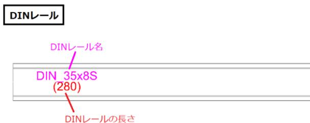
DIN レール作成後、DIN レールの名前、長さを表示する長さは括弧付きで表示されます。
