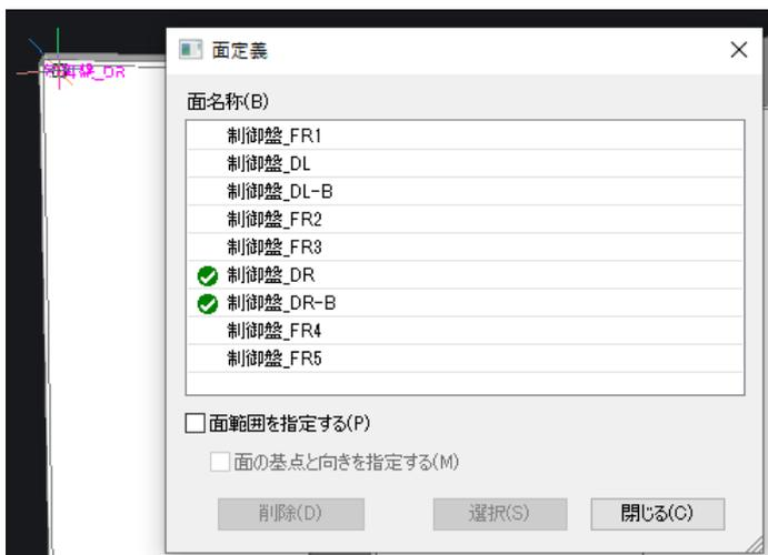
1. メニューの[3D 盤図]-[面定義]を選択し面定義ダイアログを表示します。
