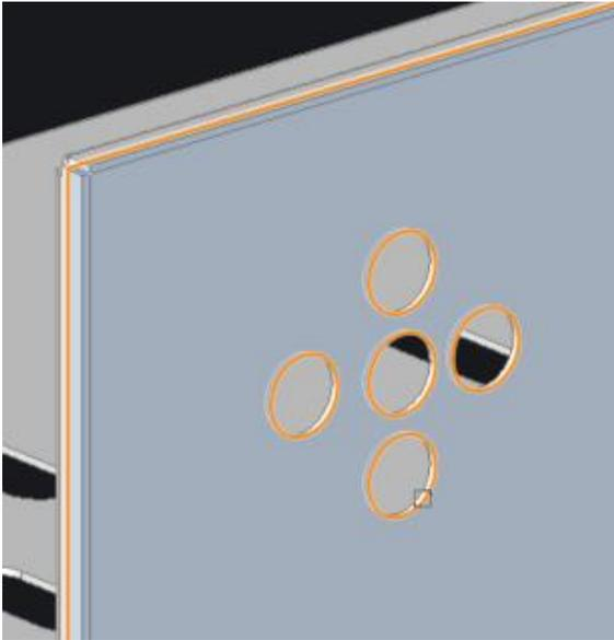
1. メニューの[3D 盤図]-[穴開け]-[穴形状変更]を選択します。
