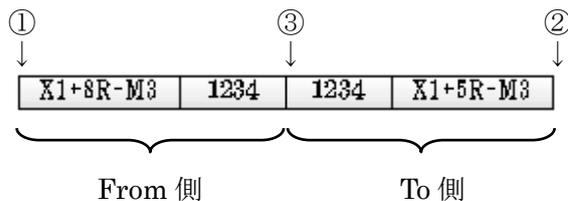
チューブの方向指定がないものは、下記のようにチューブを挿入し、処理表または捨てチューブの端末種別情報を確認して指定の圧着を行ないます。下記例では、M3になります。
