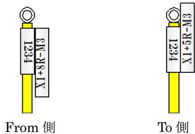
方向指定がある場合は、捨てチューブを折り曲げた状態にして「<」「>」のあるほうから電線を挿入して指定の圧着を行います。
