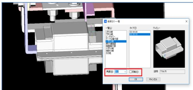
タイプ項目をダブルクリックすると、カバーが表示されますので、角度を変えながら、配置します。
