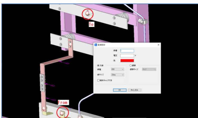
From側の接続箇所、To側の接続箇所を指示すると、「配線設計」ダイアログが表示されます。
