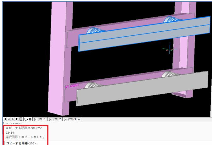
「方向指示:」と、表示されるので、矢印を上方向に向け、マウスをクリックし、コピーする距離をコマンドラインに入力します。
