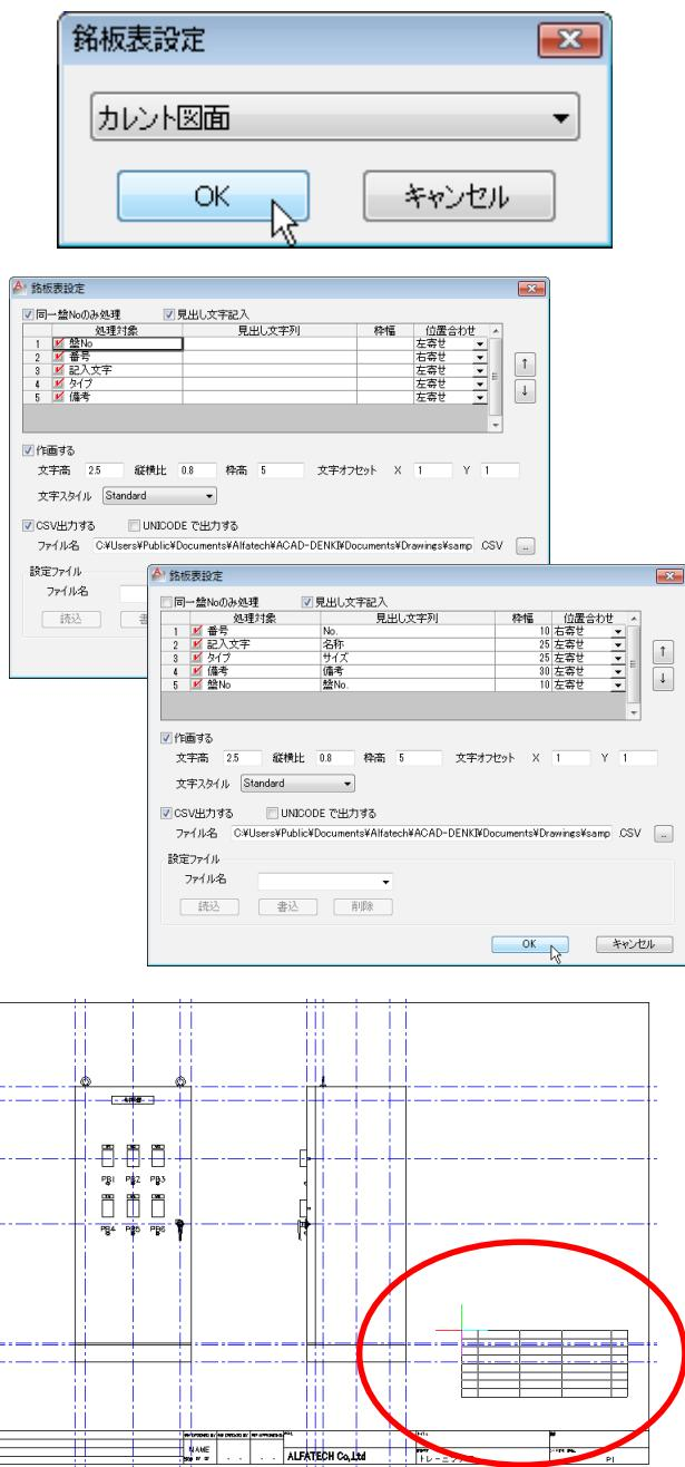
図面内の銘板シンボルから情報を取得し、銘板表を作成します。
