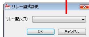
「リレー型式」に空のコイルに、展開表個別配置を実行し、リレー型式変更ダイアログのリレー型式も空のまま選択しない場合、環境設定に指定された器具展開表が配置対象となります。
