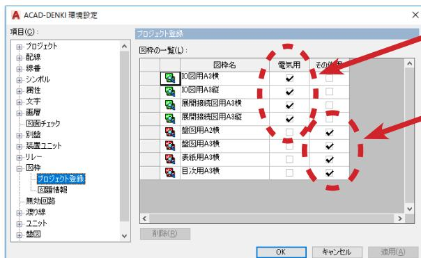
「電気用」にチェック：電気図枠として認識
