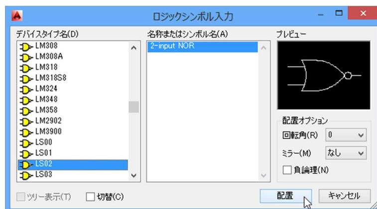
※デバイスタイプ名の表示は、上側に電源コモン/非ゲート種別、下側にゲート種別となっています。スクロールをダウンするか、文字列を入力して検索するとゲート種別が表示されます。
