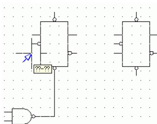
5. 右図を参考に一番右に配置した「SAMPLE\_LS」シンボルの端子を指示します。
