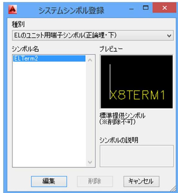
4. [電子回路]-[EL ユニット]-[EL端子配置]を選択します。
