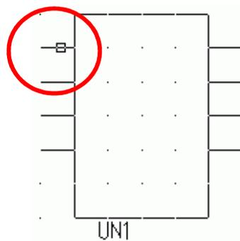
4. 選択した端子に「1」が表示されます。コマンドラインに「PIN1 属性に "2" を入力するシンボルを選択:」と表示されます。
