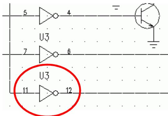
6. [電子回路]-[ゲート割付入力変更] を選択します。
