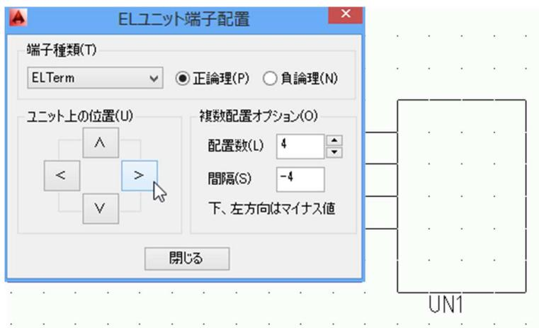
7. コマンドラインに「端子シンボル [ELTerm4]配置先を指定(戻る:リターン):」と表示されます。
