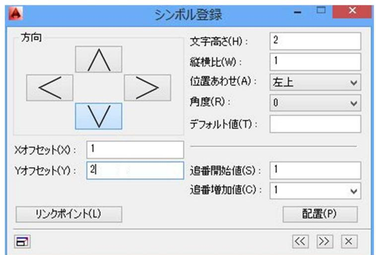
15. 右図のように、下側の線分の先端に端子を配置します。
