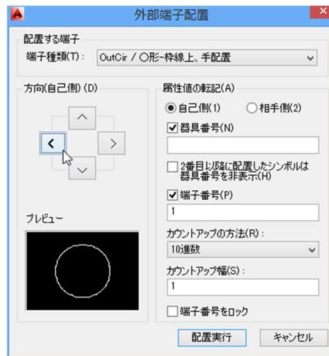
3. コマンドラインに「端子シンボル <OutCir3>配置位置を指定(戻る:リターン):」と表示されます。右図を参考に配置位置をクリックして指定します。
