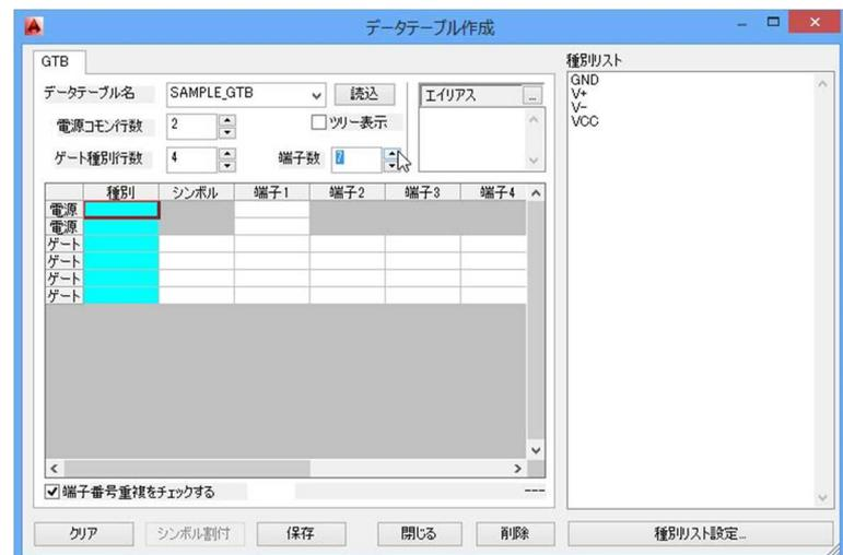
3. 電源コモン 1 の種別セルを選択し、種別リストから「VCC」をダブルクリックします。
