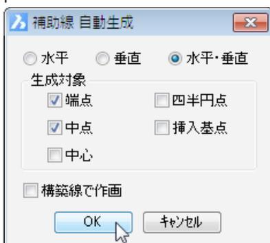
1. [ 盤図 ]-[ 補助線 ]-[ 水平・垂直線自動生成 ] を選択します。
