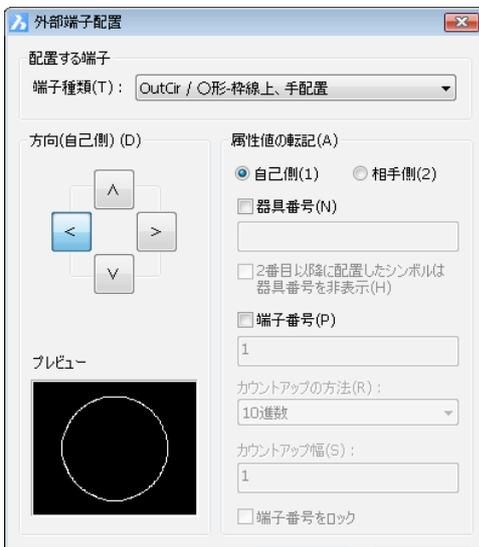
1. [シンボル] - [端子シンボル配置] - [外部端子配置] を選択します。
