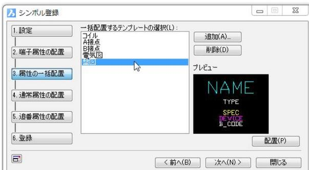
25. 一括配置するテンプレートの選択から 盤図 を選択します。
