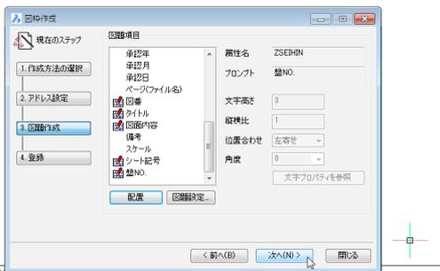
51. 左図を参考に、[ タイトル ] [ 図面内容 ] [ シート記号 ] [ 盤 No. ] の配置位置をクリック指示します。
