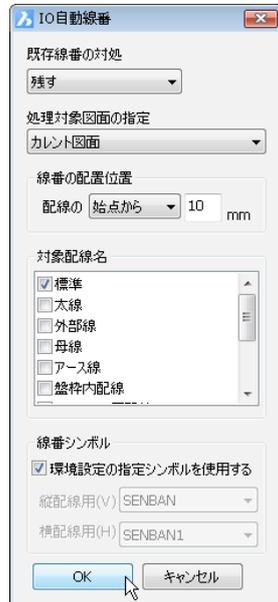
1. [電気編集] - [IO 図作成] - [IO 自動線番] を選択します。
