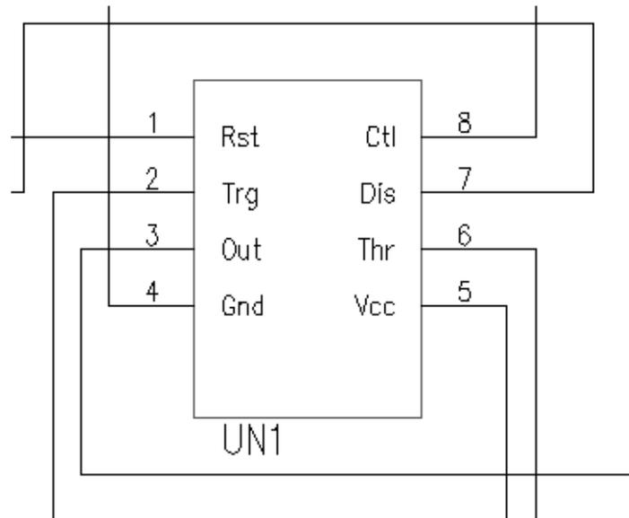
右図は、[システムシンボル登録]で「ELのユニット用端子シンボル(正論理・左)」の"ELTerm3"を選択し、編集状態にした例です。
