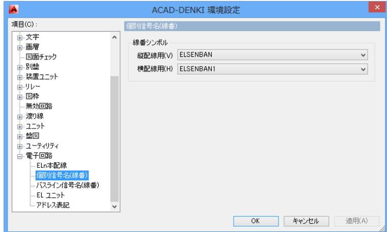
※線番シンボル「縦配線用/横配線用」の右側[V]をクリックして、リストを表示させます。
