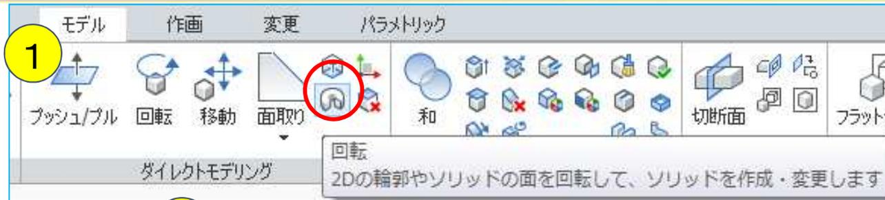
1. メニューの「モデル」「ダイレクトモデリング」「回転」を選択しダイアル形状を作成します。
